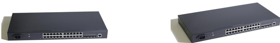
**产品描述** LGS2000-PH-24GE4XF-M 是一款工业级三层以太网交换机，支持4个万兆光口，24个千兆电口，面向交通、电力、电信、公安、石油石化、银行、煤炭、水利、铁路、冶金、军队、民航等行业，可以满足高性能比千兆接入、万兆上行的需求。产品采用高性能低功耗网络处理器，提供千兆缓速转发性能，支持绿色以太网的线路休眠能力，具有业内同级设备的最低功耗，支持强大的QoS及ACL功能，支持IP+MAC+端口绑定等安全特性，支持业务流分类及报文优先级标记，支持静态数据包采样、SFLOW功能，支持多端口镜像分析功能，支持静态及灵活QoS功能，支持Ethernet OAM 802.3ag (CFM)、802.3ah (EFM)，支持基于策略的IPV4/6单播路由，支持灵活的转发策略。具备先进的绿色环保技术，为用户提供高性能、易管理、低成本的千兆接入解决方案。
